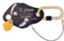
Dispositivo anticaduta scorrevole compatto per corda intrecciata multiuso. Resistenza > 15 kN. Funziona su corda intrecciata in poliammide di diametro 11 mm. Fornito completo di connettore. Camma per il bloccaggio manuale dello scorrimento che permette il lavoro su piani inclinati mantenendo la posizione (EN358).
